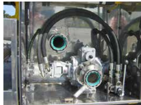
PUMPPRINCIP SJÄLVSUGANDE LAMELLPUMP
